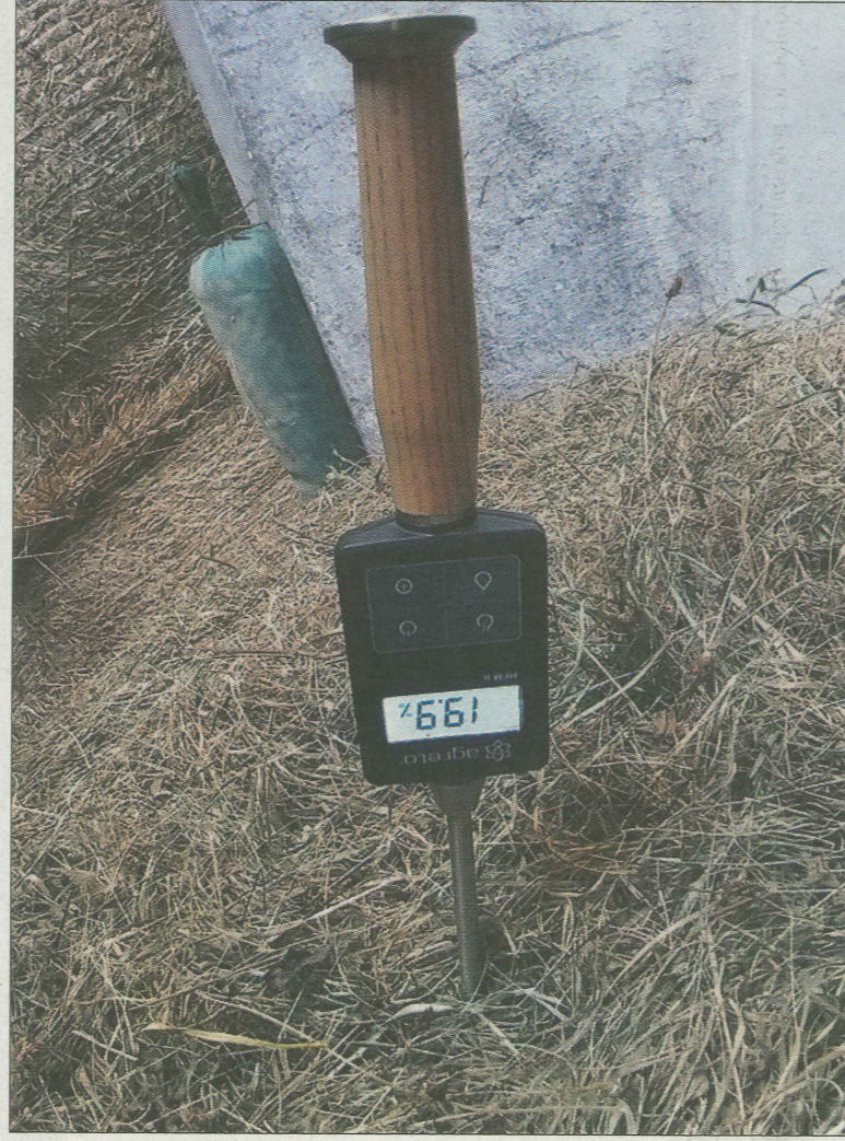
Slika 1: Merjenje temperature in vlage v balah z merilcem, katerega tipalo mora biti dolgo vsaj 0,5 metra ali 1 meter, tako da dosežemo sredino bale. (fotografija: Rok Samec)
