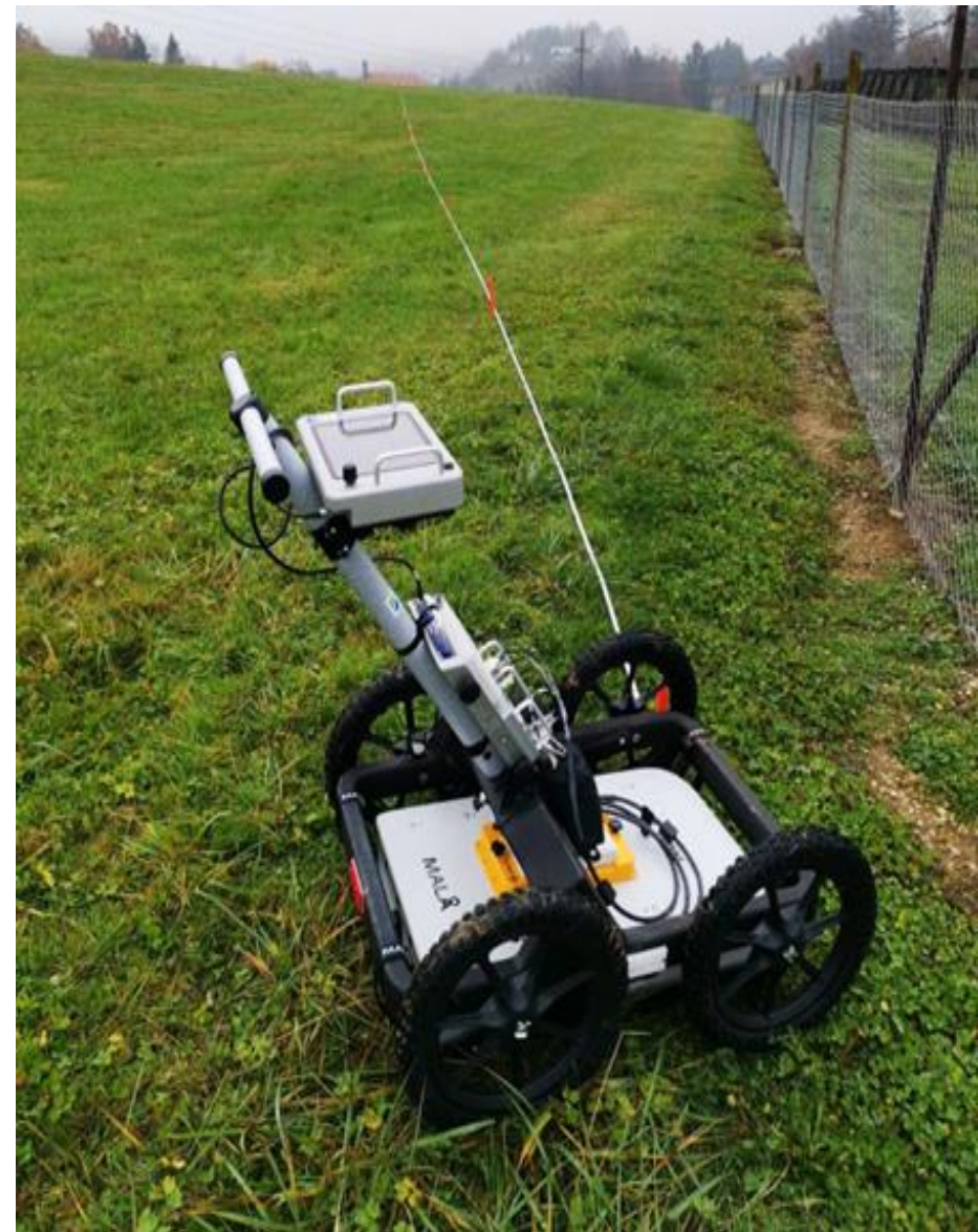
terenski voziček s kontrolno enoto, anteno in monitorjem
